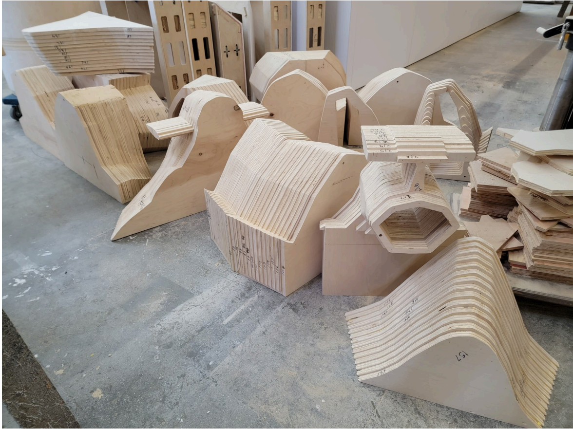
廠內地上的斷面堆：每一疊是同一道曲線的骨架，鉛筆編號寫在側面。造型自由的代價是件數。
