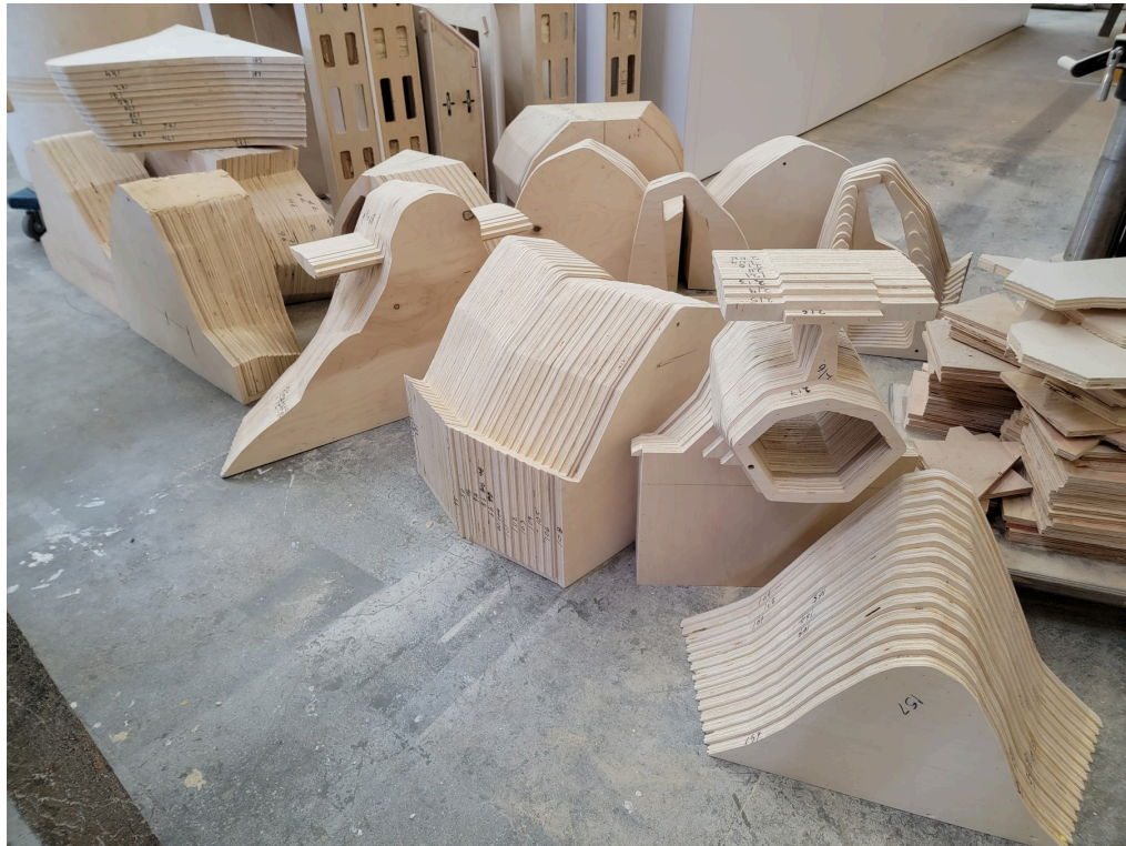
厂内地上的断面堆：每一叠是同一道曲线的骨架，铅笔编号写在侧面。造型自由的代价是件数。
